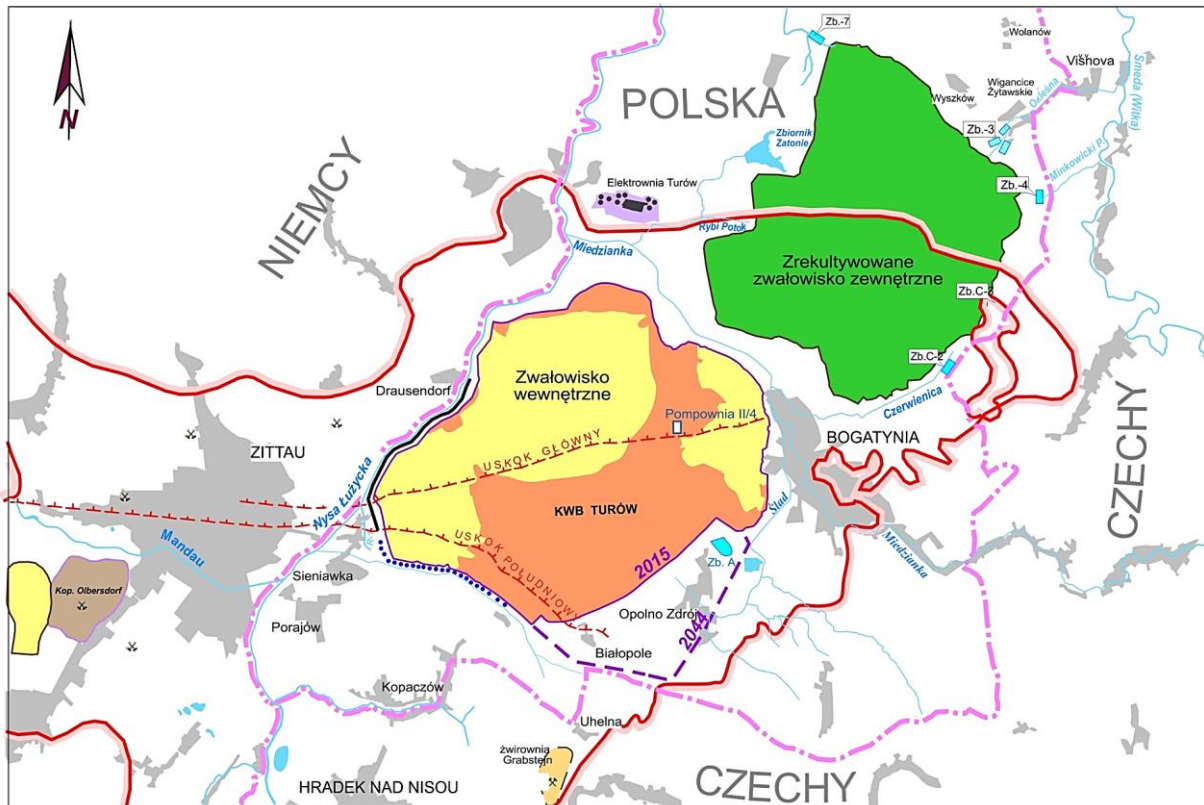
Obrázek č. 4: Situační schéma dolu Turów. Zeleně jsou vyznačeny rekultivované vnější výsypky, žlutě vnitřní výsypky, oranžově – jáma dolu Turów I. a II., červená plná čára rozsah pánevních sedimentů, čerchovaná červená čára – hlavní tektonické linie, modrá tečkovaná čára – hydraulická bariéra čerpání podzemních vod, fialová přerušovaná čára představuje rozšíření záměru těžby do r. 2042. (převzato z prezentace Venery a kol. 2016).
