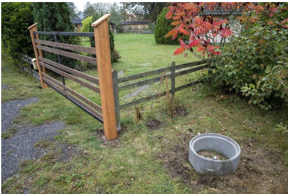
Obr. 10: Bod stabilní nivelační monitorovací sítě v osadě Uhelná. (Foto DIAMO s.p.)
